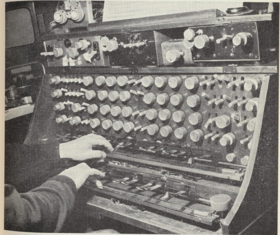
Abb. 1 Mixtur-Trautonium mit Saitenmanualen, Registern und elektronischem Schlagwerk.
